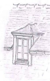
Lucarne engagée dans le mur « à capucine »
